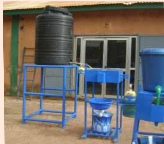
les kits de lavage de mains à pédales innové par FAPEL GUINEE avec un réservoir de 1000L
