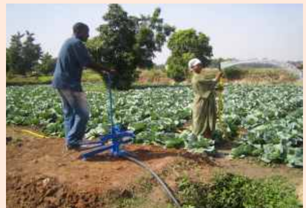
Une pompe à pédales pour l'irrigation et arrosage pour les étangs, mares et marigots
